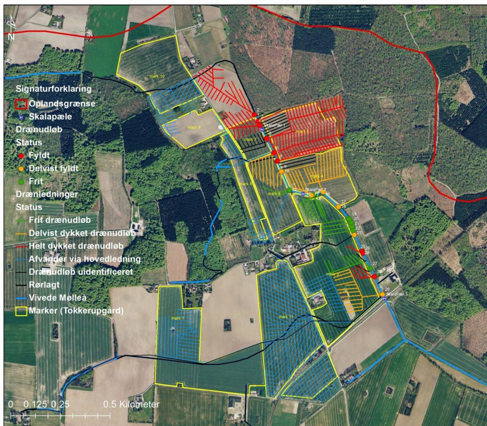
Figur 4-4 Oversigt over drænudløbnes påvirkning af vandstanden og en indikation af de bagvedliggende drænledninger på strækning 1 af Vivede Mølleå. Jf. Bilag D.
