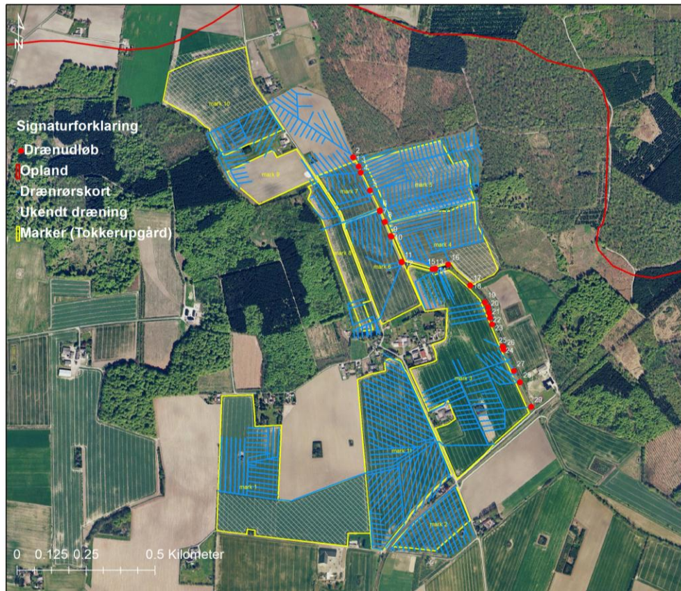
Figur 4-3 Drænanlægget på Tokkerupgård's marker, hvor drænstrøgene udgør 39,3 km.
